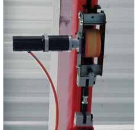
Servomoteur pour déplacement selon les axes X et Y.
